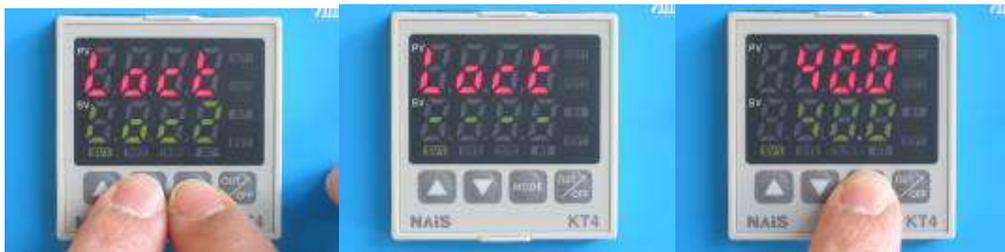
まず、設定変更禁止を解除します。解除を行うと、**重要な設定値も変更可能となりますので、次の説明に従って正しく操作してください。**
