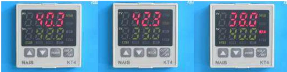
ヒーター出力の時は、温度調節器の **OUT1** が**緑色**に点灯します。(写真左)
