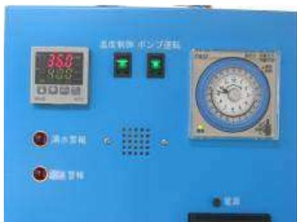
温度制御スイッチを ON にしてください。温度調節器の電源が入ります。
