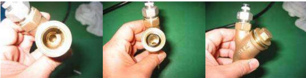
掃除後、パンチングメタルを組付ける際、奥の溝（写真左）に確実にはめ込み、蓋の溝にも確実にはめ込む様に、注意しながら組んでください。
