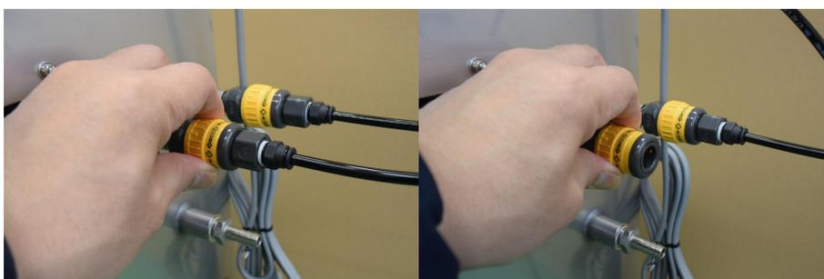
カプラは黄色の部分をスライドさせると外れます。回すとロックが掛かりますので、スライドしない場合は回してロックを解除してください。
