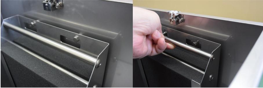
フィルタボックスはネジに引っ掛けてあるだけですので、少し持ち上げ、本体前面側にスライドさせ、戻りホースを抜けばそっくり外せます。フィルタも上から差し込んであるだけです。
